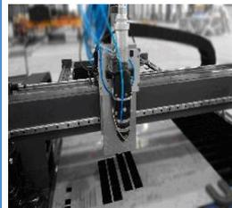
切断や穴あけ加工用に、ファイバーレーザ光の集光に用います。自動的に加工対象物からの高さ(作業距離)を維持する高さセンサーユニット(HSU)と一緒に取り付けられます。
