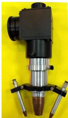
WLD-808/980-F120は、PCBのハンダ付け用に特別に設計された溶接機ヘッドです。レーザービームはコリメートされ、チップの足部分に集光されます。同時に、ハンダ付けする錫は、足位置に置かれ、レーザー焦点位置の高いパワー密度によって下へ溶けてハンダ付けが行われます。
