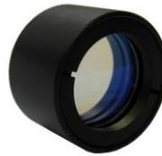
溶融石英製で低吸収コーティングです。1000W以上のYAGレーザー用で、集光レンズに保護ウインドウが付きます。水冷用として、レンズとウインドウをそれぞれ別個に提供することも可能です。
