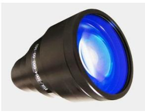
F- $\theta$  スキャンレンズの上位バージョンで、ビームが結像面につねに直角になるように設計されています。位置エラーやイメージの歪みがスキャン範囲全面にわたって最小限に抑えられます。
