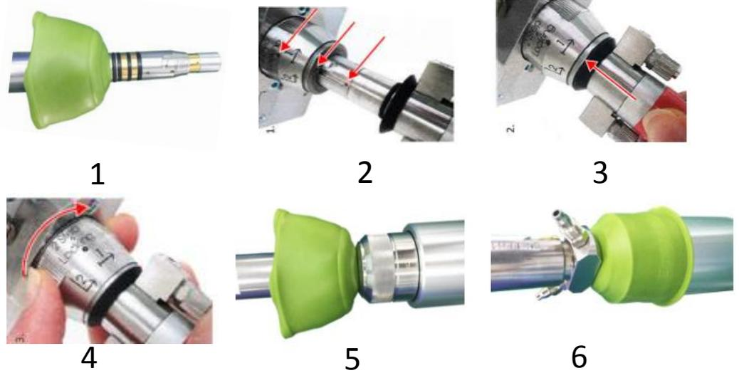
注：レーザヘッドは、ファイバーを挿入するときは水平にしてから、ファイバーを水平に挿入してください。
