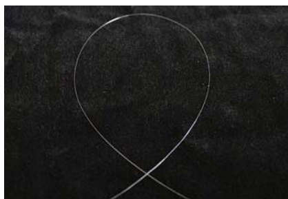
図1 アンクラッドYb:YAG単結晶ファイバ(SCF)は直径がわずか100 \mu mであり、完全導波路レーザ動作を示す(提供:シャスタ・クリスタルズ社)。
