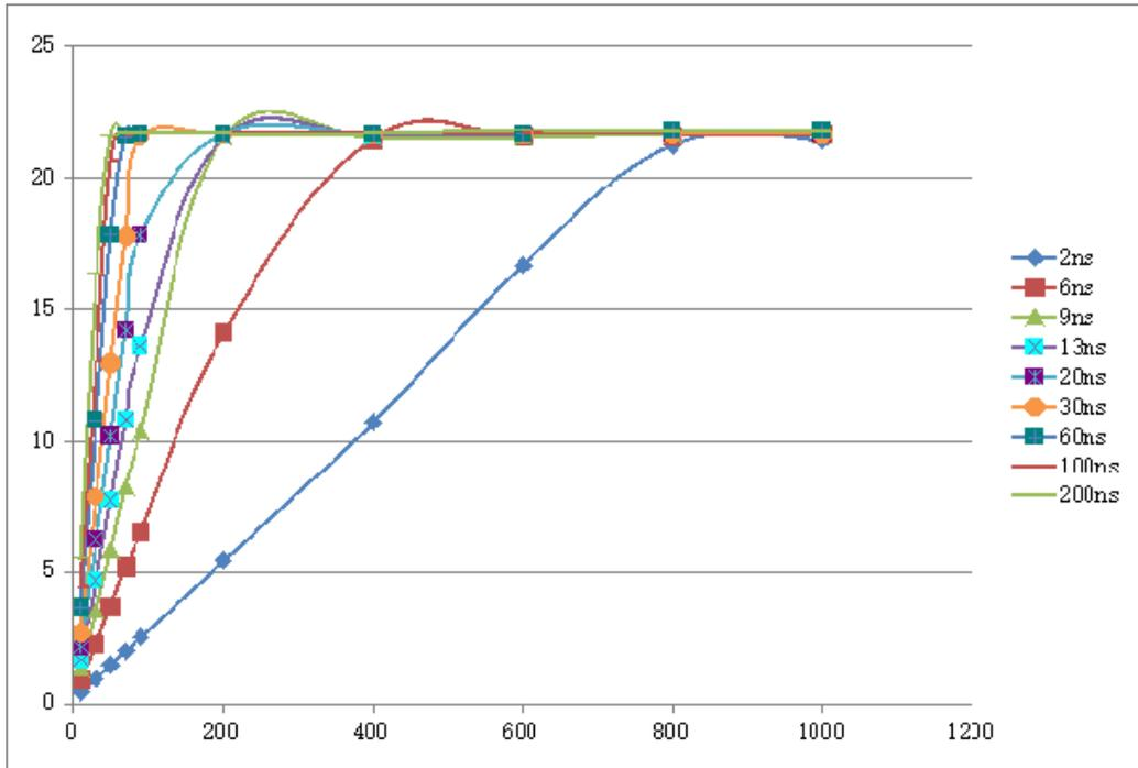
図-5 異なるパルス幅および周波数における M6+の最大負荷時の実際の出力曲線
