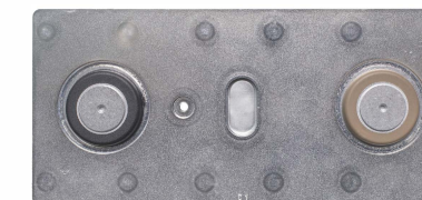
バッテリーパッキンの溶接
