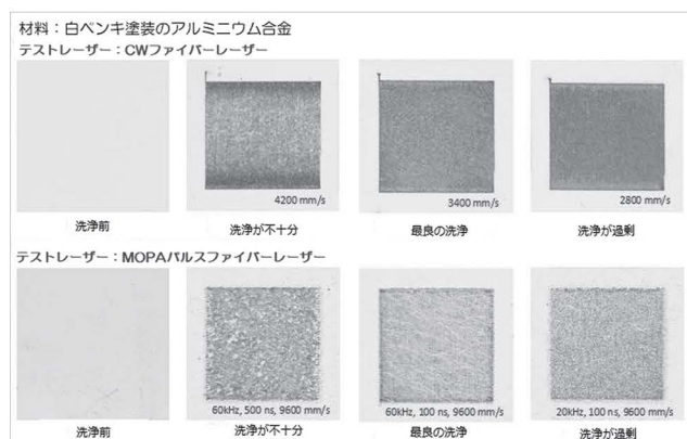
写真2 白いペンキを塗ったアルミニウム合金の洗浄性能
