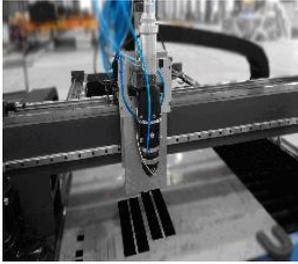
切断や穴あけ加工用に、ファイバーレーザーからのレーザー光の集光に用います。自動的に加工対象物からの高さ(作業距離)を維持する高さセンサーユニット(HSU)と一緒に取り付けられます。
