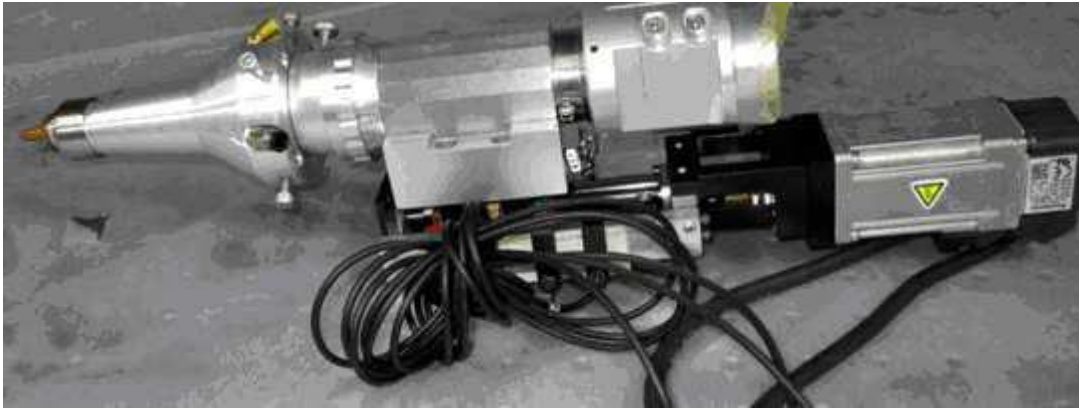
サーボモーター装備の線形ガイド装置に取り付けられたヘッド
