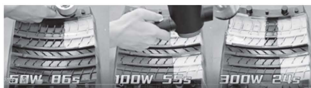
写真7 レーザーのパワーと洗浄時間
